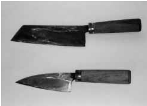
菜切包丁(上)と小魚包丁 包丁の手入のコツは真っ平らな中砥、仕上げ砥で研ぐこと。使ったあと80度位の湯に通し布で必ず拭くこと。
