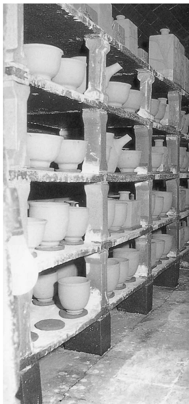
棚積みがほぼ完成した窯の中のようす (写真は現在の島岡窯の登り窯)
